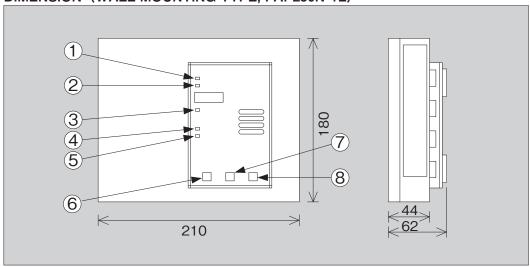
①AC POWER-ON LAMP ②AUXILIARY POWER LAMP ③FIRE ALARM LAMP ④LINE FAULT LAMP
